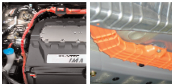
Des câbles orange sous le capot ou des boucliers orange boulonnés sous la voiture indiquent que l'on est en présence d'un véhicule hybride.
