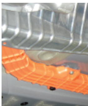
Bouclier haute tension boulonné sous la caisse
