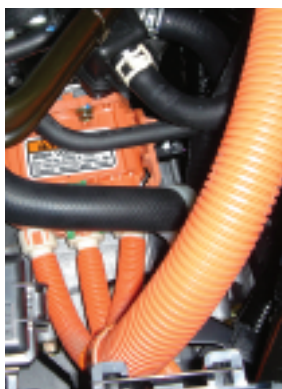
Connection des câbles haute tension au moteur électrique
