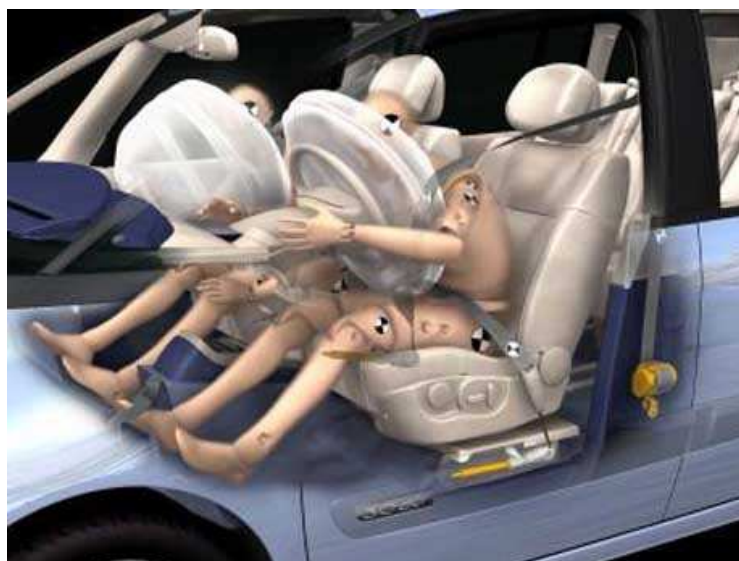
Sur une Fiat Multipla, l'airbag frontal est dimensionné pour la protection de 2 passagers
