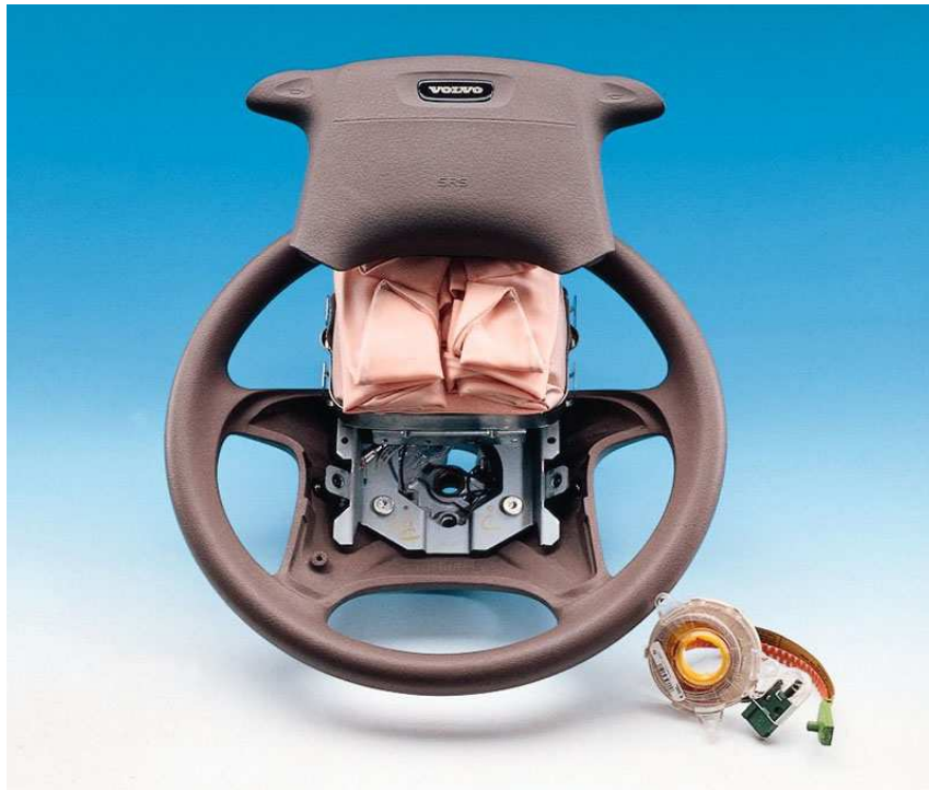
Détail d'un airbag de volant - générateur de gaz, sac, couvercle et faisceau électrique.
