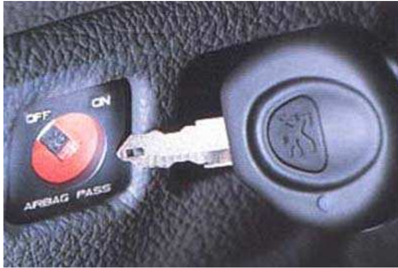
Système de neutralisation de l'airbag passager sur Peugeot
