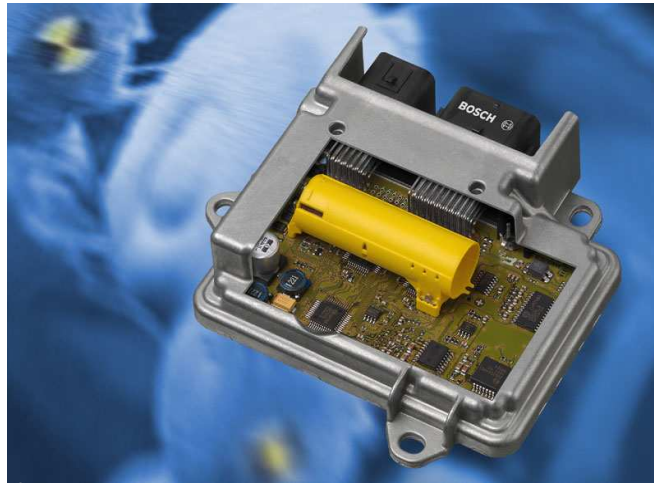
9 ème génération de boîtier de commande d'airbags Bosch
